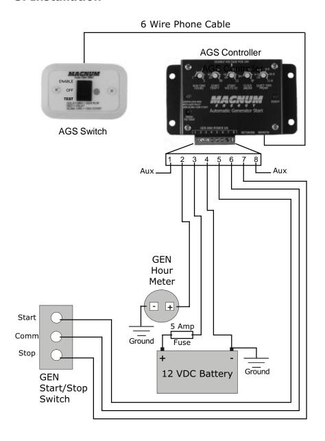
Figure 4 - AGS Wiring Diagram
