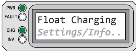
**Ilustración 5-12, Modo de carga de flotación**
