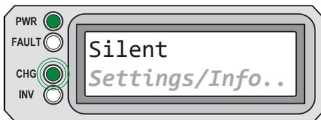
**Silent** aparece en la pantalla LCD. el LCD (verde) PWR está fijo y el LED (verde) CHG parpadea. El LED (rojo) FAULT está apagado, el LED (verde) INV puede aparecer encendido o apagado.
