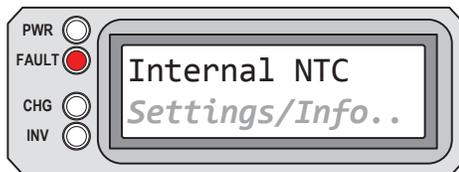
**Internal NTC** aparece en la pantalla LCD. El LED (rojo) FAULT está encendido. Los LED PWR (verde), CHG (verde) e INV (verde) están apagados.
