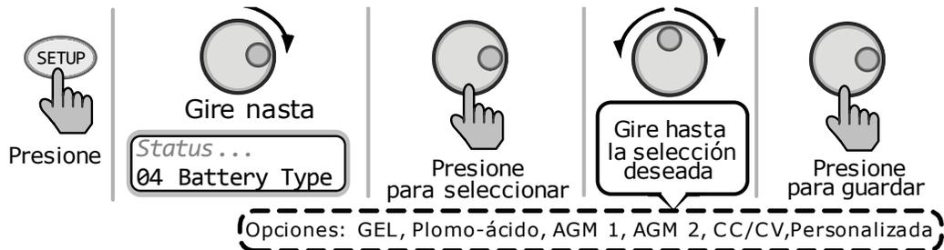
**Ilustración 3-9, CONFIGURACIÓN: 04 Selección del tipo de batería**
