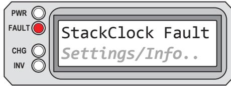
**StackClock Fault** aparece en la pantalla LCD. El LED (rojo) FAULT está encendido. Los LED PWR (verde), CHG (verde) e INV (verde) están apagados.
