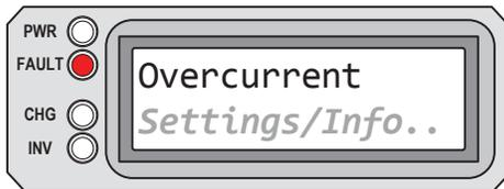
**Overcurrent** aparece en la pantalla LCD y el LED (rojo) FAULT está encendido. Los LED PWR (verde), CHG (verde) e INV (verde) están apagados.
