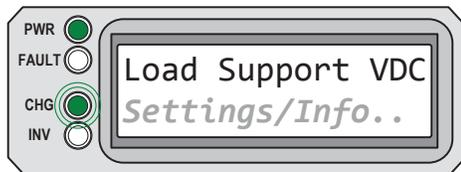
**Load Support VDC** aparece en la pantalla LCD. El LCD (verde) PWR está fijo y el LED (verde) CHG parpadea. el LED (rojo) FAULT está apagado, el LED (verde) INV puede aparecer encendido o apagado.
