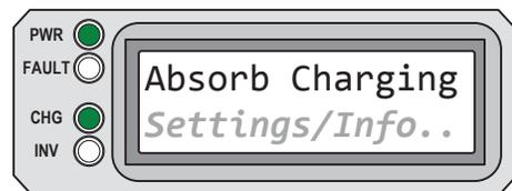
**Absorb Charging** aparece en la pantalla LCD; el LCD (verde) PWR está fijo y el LED (verde) CHG normalmente se encuentra fijo, pero puede parpadear. el LED (rojo) FAULT está apagado. el LED (verde) INV puede aparecer encendido o apagado.
