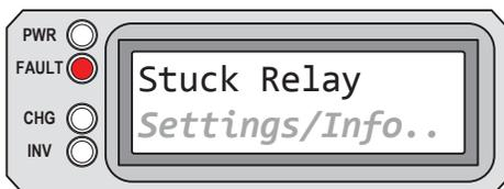
**Stuck Relay** aparece en la pantalla LCD. El LED (rojo) FAULT está encendido. Los LED PWR (verde), CHG (verde) e INV (verde) están apagados.
