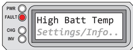
**High Batt Temp** aparece en la pantalla LCD. El LED (rojo) FAULT está encendido. Los LED PWR (verde), CHG (verde) e INV (verde) están apagados.
