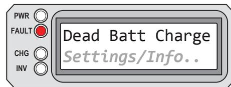
**Dead Batt Charge** aparece en la pantalla LCD. El LED (rojo) FAULT está encendido. Los LED PWR (verde), CHG (verde) e INV (verde) están apagados.
