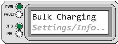
*Ilustración 5-8, Modo de carga intensa (bulk)*
