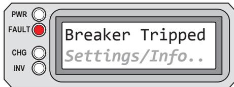
**Breaker Tripped** aparece en la pantalla LCD. El LED (rojo) FAULT está encendido. Los LED PWR (verde), CHG (verde) e INV (verde) están apagados.
