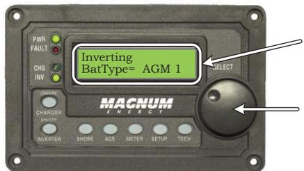
Gire la perilla **SELECT** hasta la configuración deseada. Cuando la línea inferior muestre la configuración deseada:
