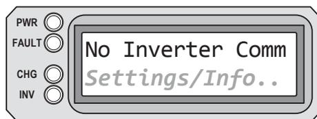
**No Inverter Comm** aparece en la pantalla LCD. El FAULT (rojo), PWR (verde), CHG (verde), y el INV (verde) LED se encuentran normalmente apagados.
