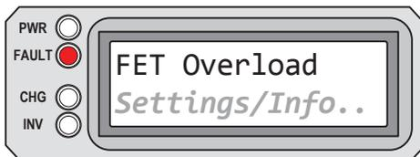
**FET Overload** aparece en la pantalla LCD. El LED (rojo) FAULT está encendido. Los LED PWR (verde), CHG (verde) e INV (verde) están apagados.
