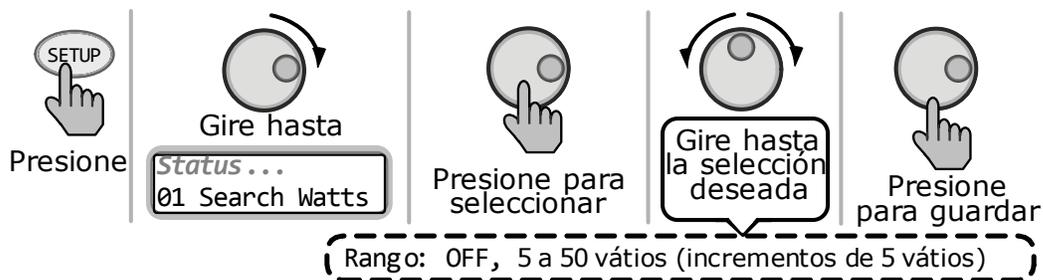
*Ilustración 3-6, CONFIGURACIÓN: 01 Búsqueda selección de watts*
