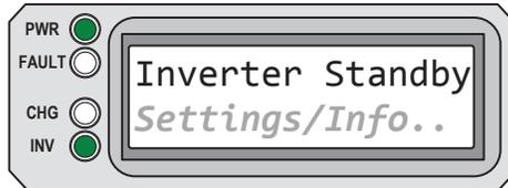
**Inverter Standby** aparece en la pantalla LCD. Los LED PWR (verde) e INV (verde) están encendidos. Los LED FAULT (rojo) y CHG (verde) LED están apagados.
