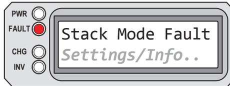
**Stack Mode Fault** aparece en la pantalla LCD. El LED (rojo) FAULT está encendido. Los LED PWR (verde), CHG (verde) e INV (verde) están apagados.
