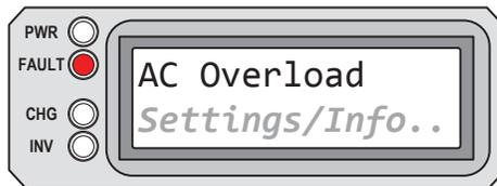
**AC Overload** aparece en la pantalla LCD. El LED (rojo) FAULT está encendido. Los LED PWR (verde), CHG (verde) e INV (verde) están apagados.
