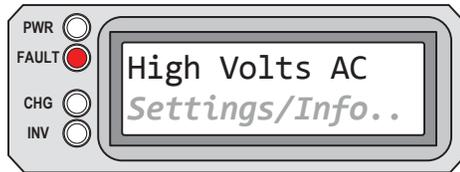
**High Volts AC** aparece en la pantalla LCD. El LED (rojo) FAULT está encendido. Los LED PWR (verde), CHG (verde) e INV (verde) están apagados.
