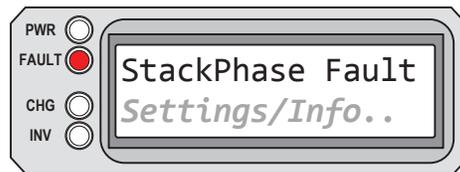
**StackPhase Fault** aparece en la pantalla LCD. El LED (rojo) FAULT está encendido. Los LED PWR (verde), CHG (verde) e INV (verde) están apagados.
