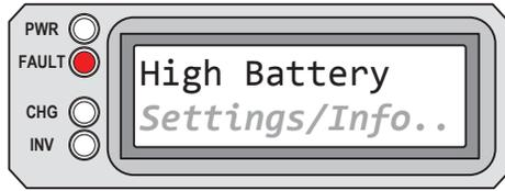
**High Battery** aparece en la pantalla LCD. El LED (rojo) FAULT está encendido. Los LED PWR (verde), CHG (verde) e INV (verde) están apagados.
