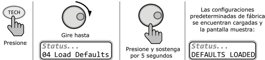
Ilustración 3-19, TECH: 04 Selección de predeterminados de carga
