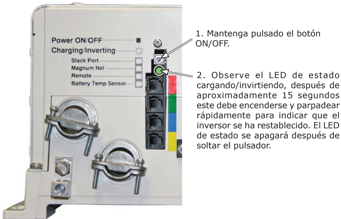
Ilustración 4-1, Realización de un reinicio del inversor
